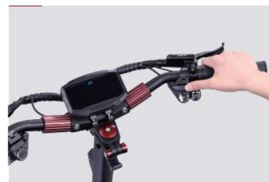
Stlačením a podržaním tlačidla napájania ho vypnete (Upozorňujeme, že batériu je možné vybrať len vtedy, keď je kolobežka vypnutá.)
