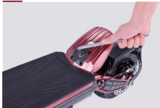
Točte zadné odpruženie smerom doprava aby ho uvoľniť.
