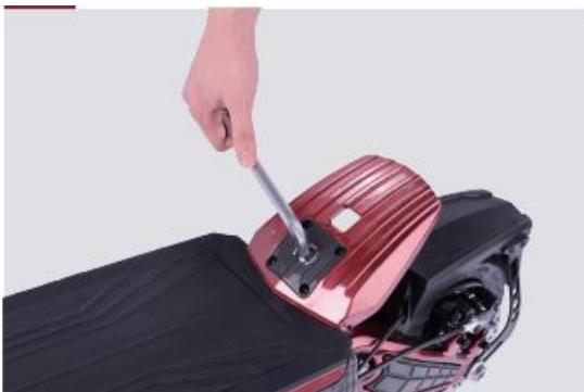
Točte zadné odpruženie smerom do ľava aby ho utiahnuť
