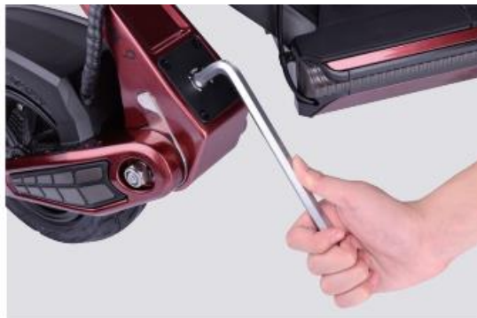
Točte predné odpruženie smerom do pravá aby ho uvoľniť
