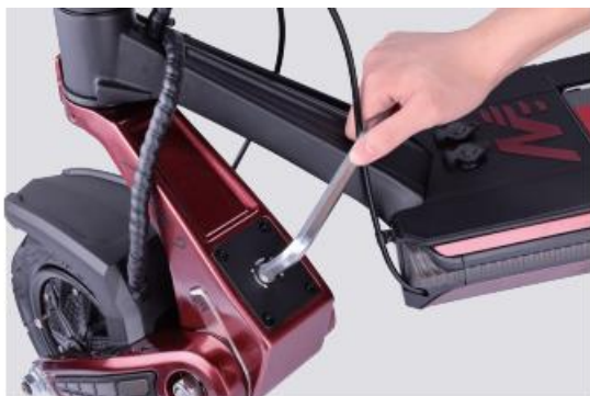
Točte predné odpruženie smerom do ľavá aby ho utiahnuť
