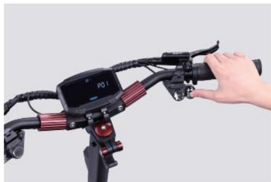
Stlačením tlačidla v štýle letectva vpravo nahor nastavte P01 na 1, čo znamená, že batéria je odomknutá
